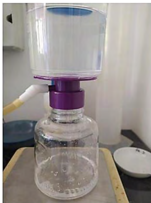
18. ábra. Filtersterilizálás a Laboratóriumban (saját felvétel)
