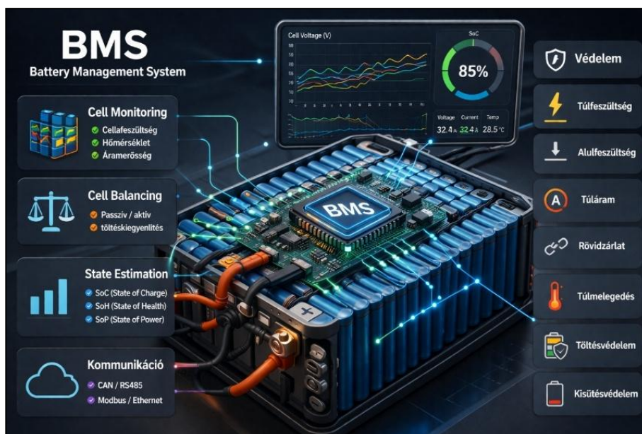
2. ábra A BMS belső felépítése és funkciói (Forrás: [10] alapján készítette a szerző)
