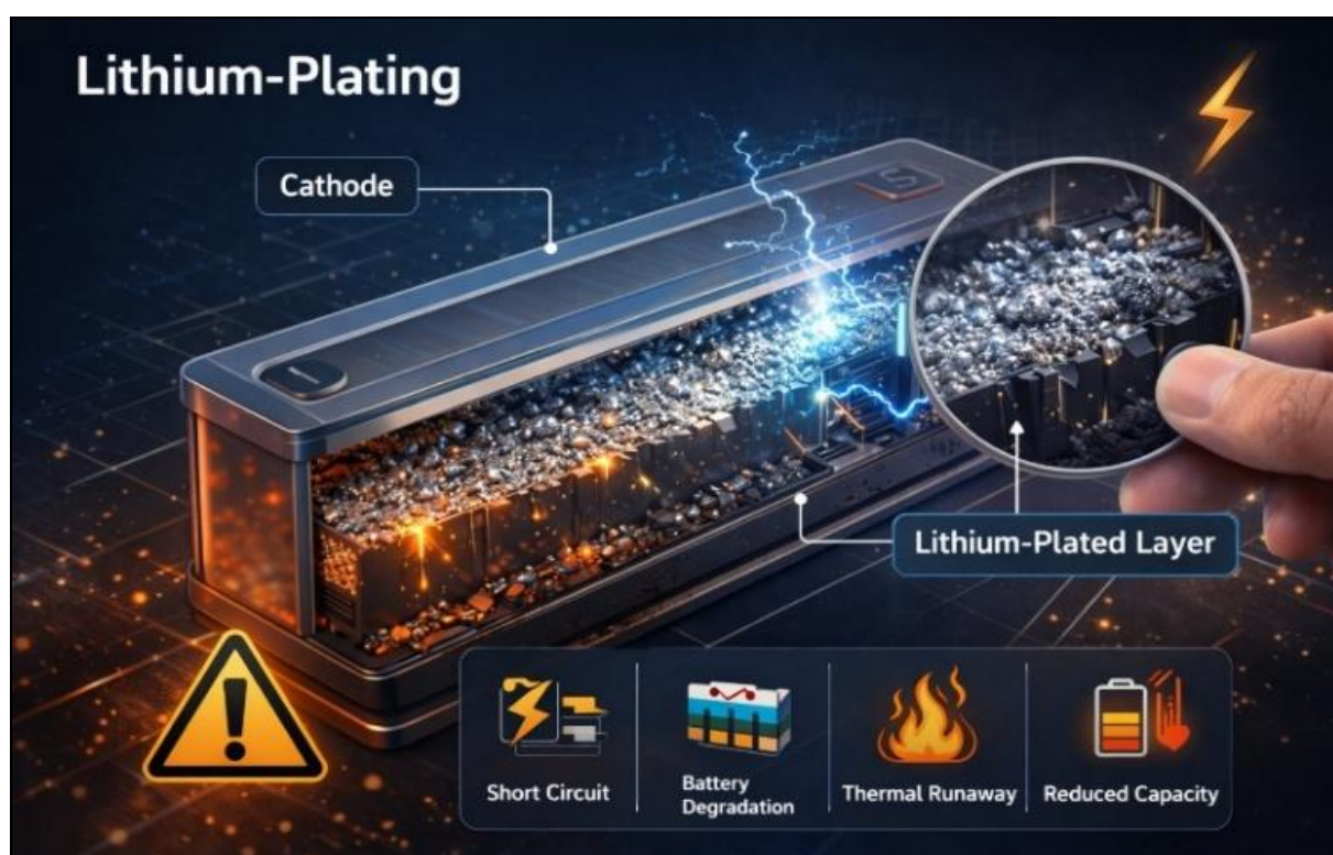
8. ábra A lítium-plating jelensége és annak biztonságtechnikai kockázatai (Forrás: [4] alapján készítette a szerző)
