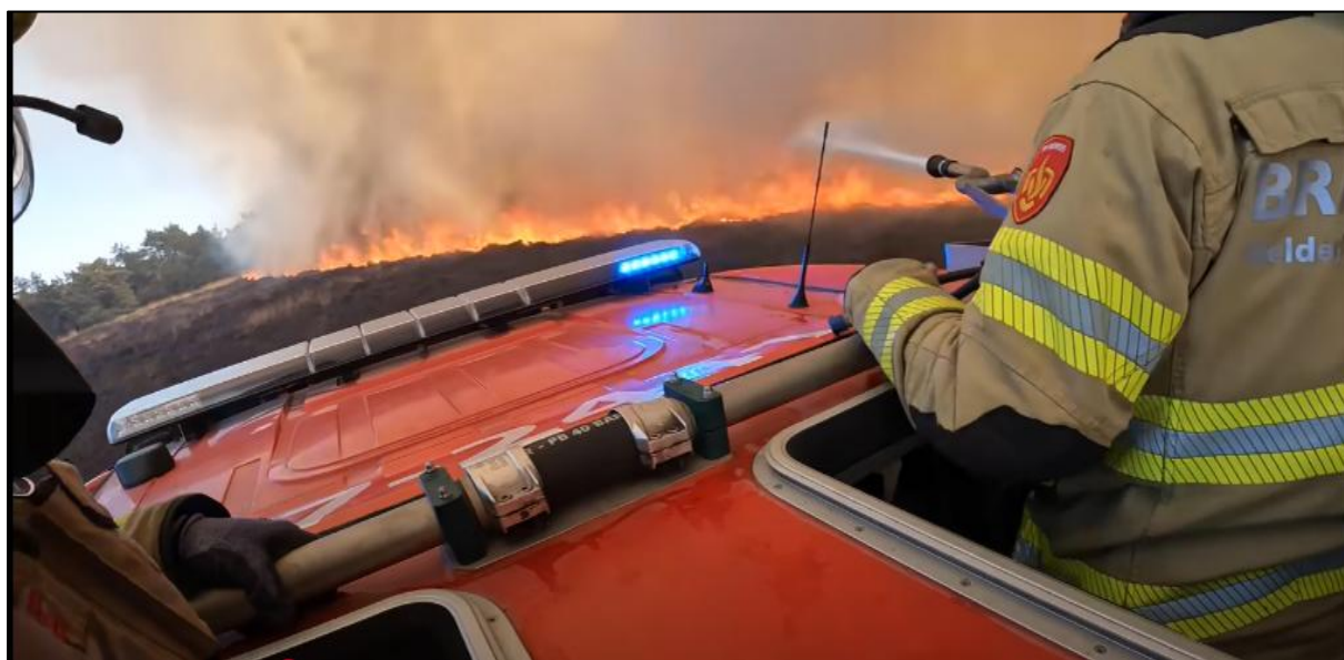
11. kép: Vízágyú alkalmazása menetközbeni oltásra, Hollandiában. (Forrás: [8])
