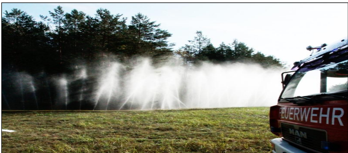
4. kép: ICONOS tömlő alkalmazása terület és gépjárműfecskendő védelme érdekében. (Forrás: [5])
