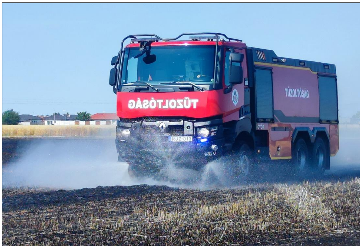
10. kép: Avaroltó üzem közben egy vízszállító gépjárművön. (Készítette: a szerző)
