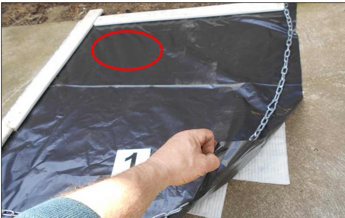
14. kép: Az 1-es szektor bal felső sarkában lett kiöntve a gázolaj (10. kép), azonban a gőzcsapda az 1-es szektor jobb alsó sarkában lett elhelyezve (készítette a szerző)
