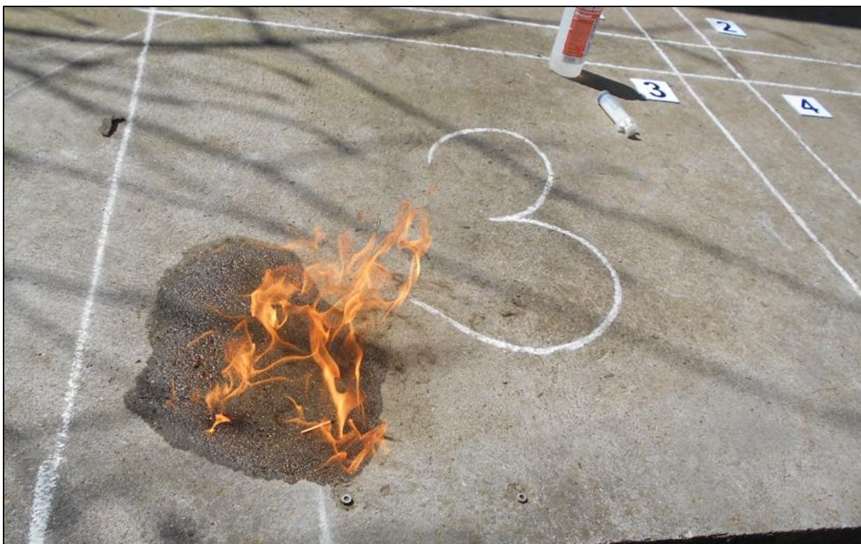
16. kép: Az 50 ml nitrohígító a 3-as szektor bal alsó sarkában lett kiöntve, majd meggyújtva (készítette a szerző)
