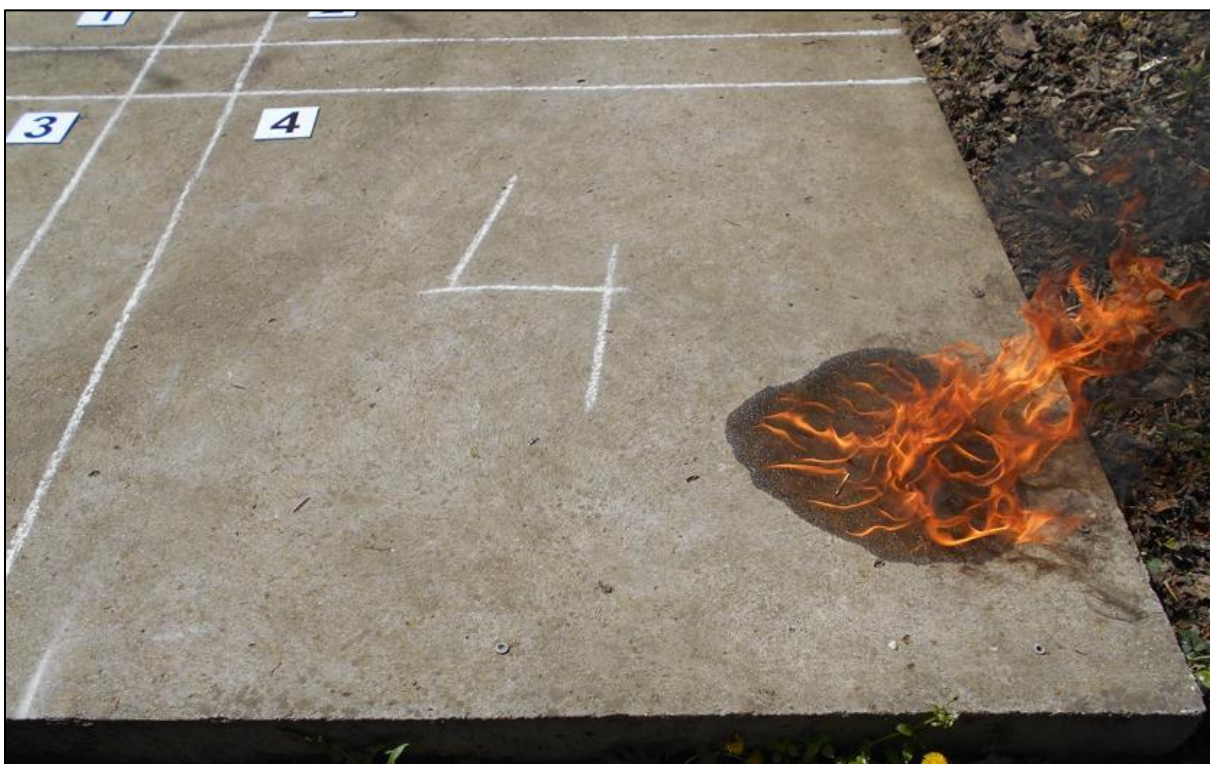
17. kép: Az 50 ml motorbenzin a 4-es szektor jobb alsó sarkában lett kiöntve majd meggyújtva (készítette a szerző)
