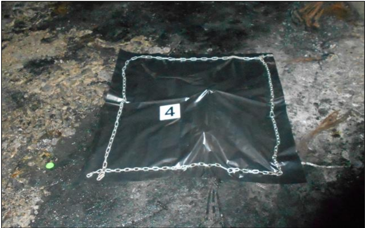
21. kép: A 20. képen látható helyszínről vett „gőzcsapdás” mintavétel a letakart mintavételi folyamat során 4 (készítette a szerző)
