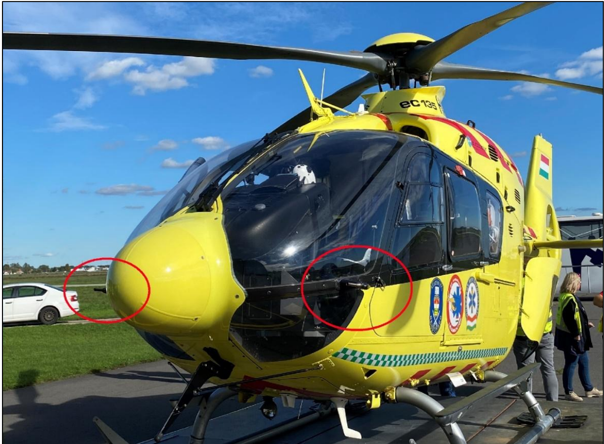
4. ábra: Az AIRBUS HELICOPTERS EC135 P2+ mentőhelikopter Pitot-csője (készítette a szerző)
