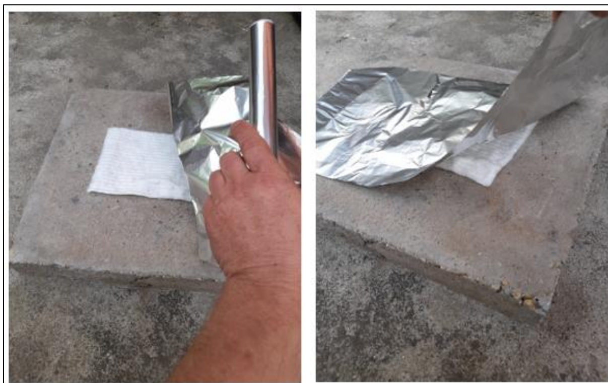
5-6. kép: Az elégett égésyorsító anyag pontosan ismert helyére el lett helyezve a textil gőzcsapda (5. kép) Majd ezt követően alufóliával a felület be lett fedve, le lett takarva (6. kép) (készítette a szerző)
