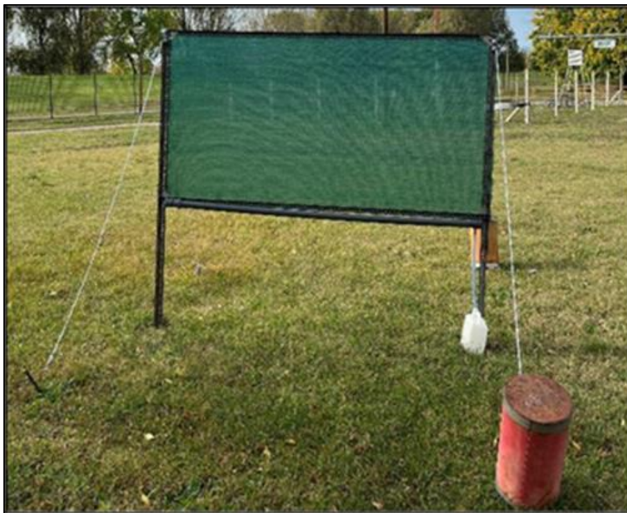
1. kép: Páragyűjtő háló a Nemzeti Közzolgálati Egyetem Víz tudományi Karán (Forrás: ld. [12])
