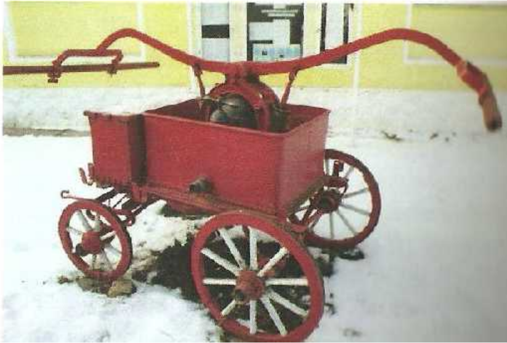
3. kép. Kocsifecskendő a hajtókarjára szerelt mozgató rudakkal
