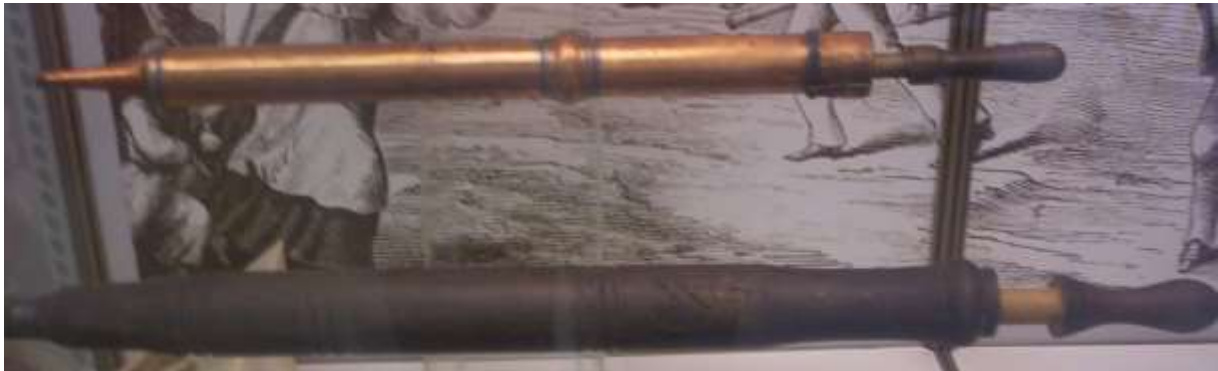
10. kép: Rézből (felső), fából (alsó) készített vízpuska
