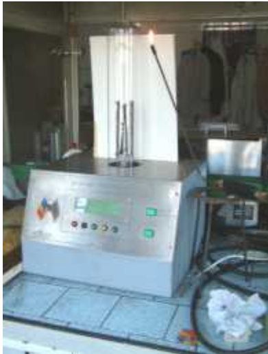
1. ábra: Az Oxigénindexet mér készülék (Ybl, T zvédelmi int.)
