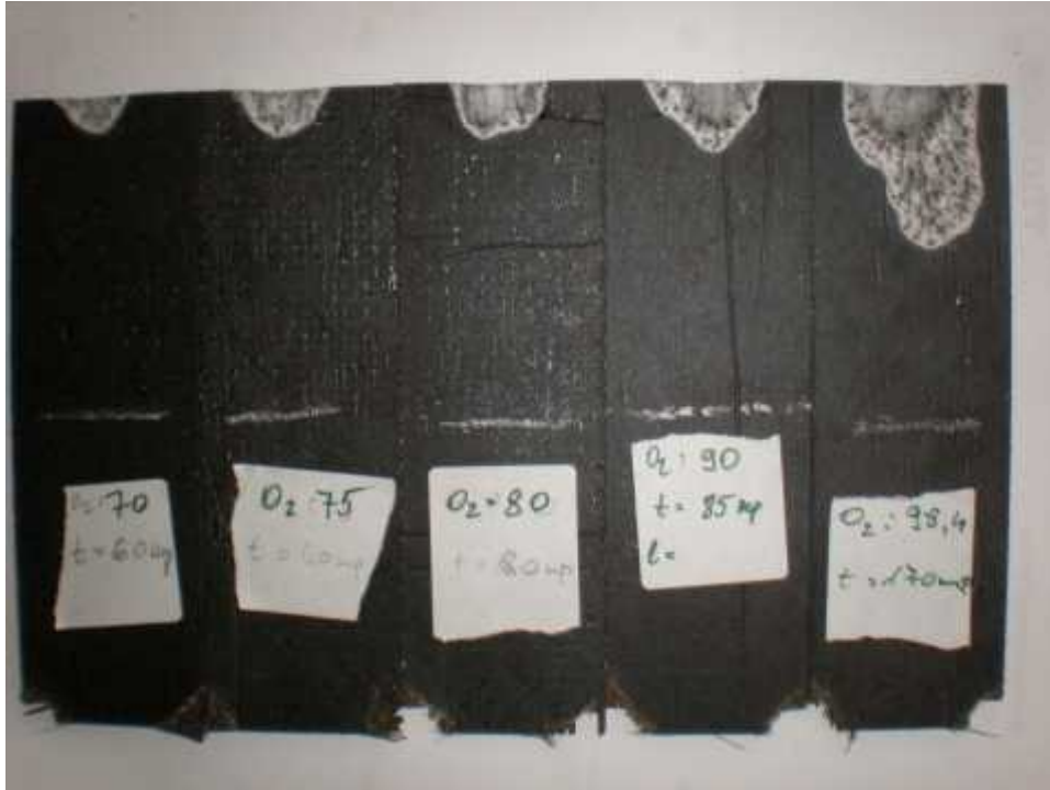
5. ábra: A m gyanta kéménybélés égés utáni károsodása különböző oxigéntartalom mellett
