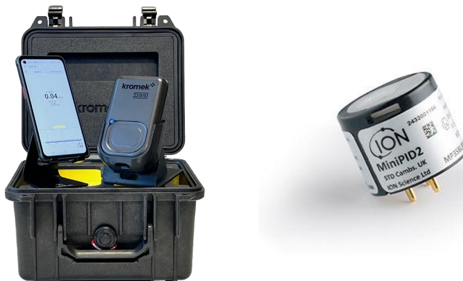
5. és 6. képek: Kromek D3S ID szcintillációs detektor (balról; forrás: ld. [31]) és Ion Science MiniPID 2 PPB XF illékony szerves vegyület (VOC) érzékelő fotoionizáció és levegőminőség-monitorozáshoz (jobbról; forrás: ld. [32])
