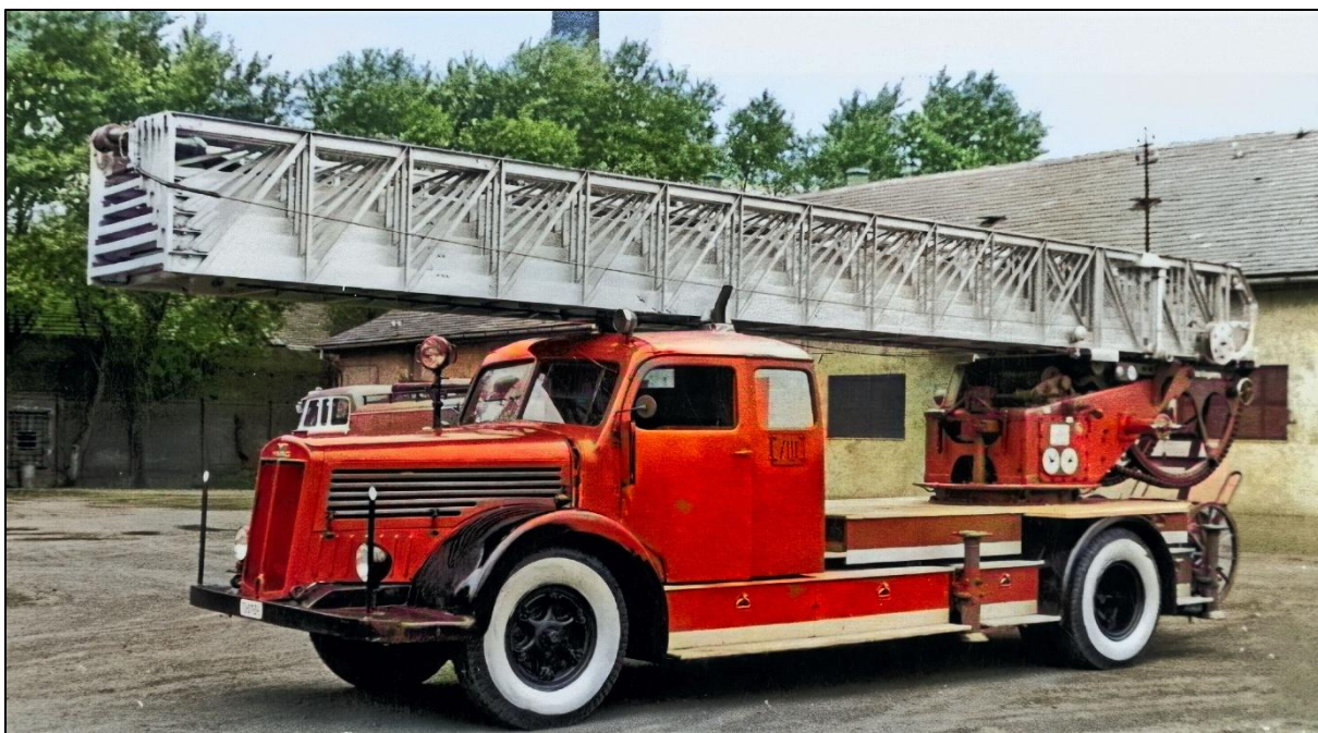
15. melléklet: A XIII. kerületi Tűzrendészeti alosztály MÁVAG-METZ típusú, 45 méteres munkamagasságú gépezetes tolólétrája. Utólag színezett felvétel. Forrás és szerkesztés: Hózer Benjámín.
