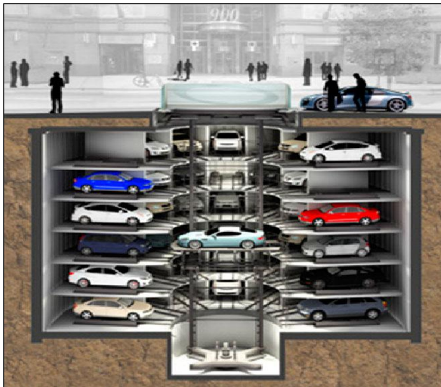
2. kép A siló típusú rendszer [5]
