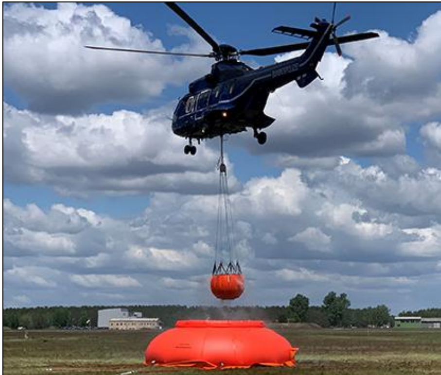
3. kép: Vízvételzés Bambi Buckettel egy nyitott mobil víztározóból. (Forrás: ld. [4])
