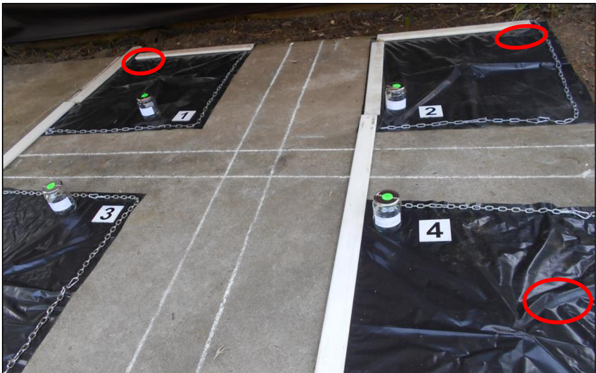
18. kép: A szektorokra osztott vizsgálati felületek letakarva. A pirossal jelölt ovális területeken történt az égésgyorsító anyag égetése (készítette a szerző)
