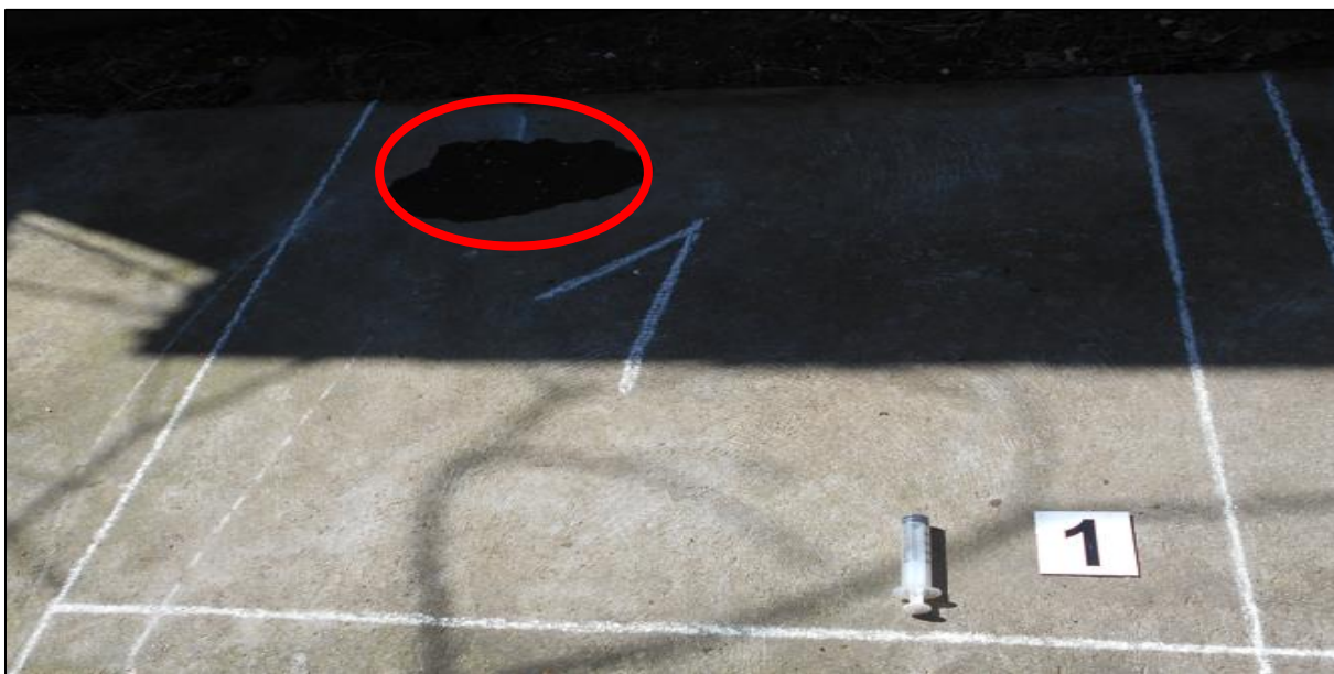
13. kép: Az 50 ml gázolaj az 1-es szektor bal felső sarkában lett kiöntve (készítette a szerző)
