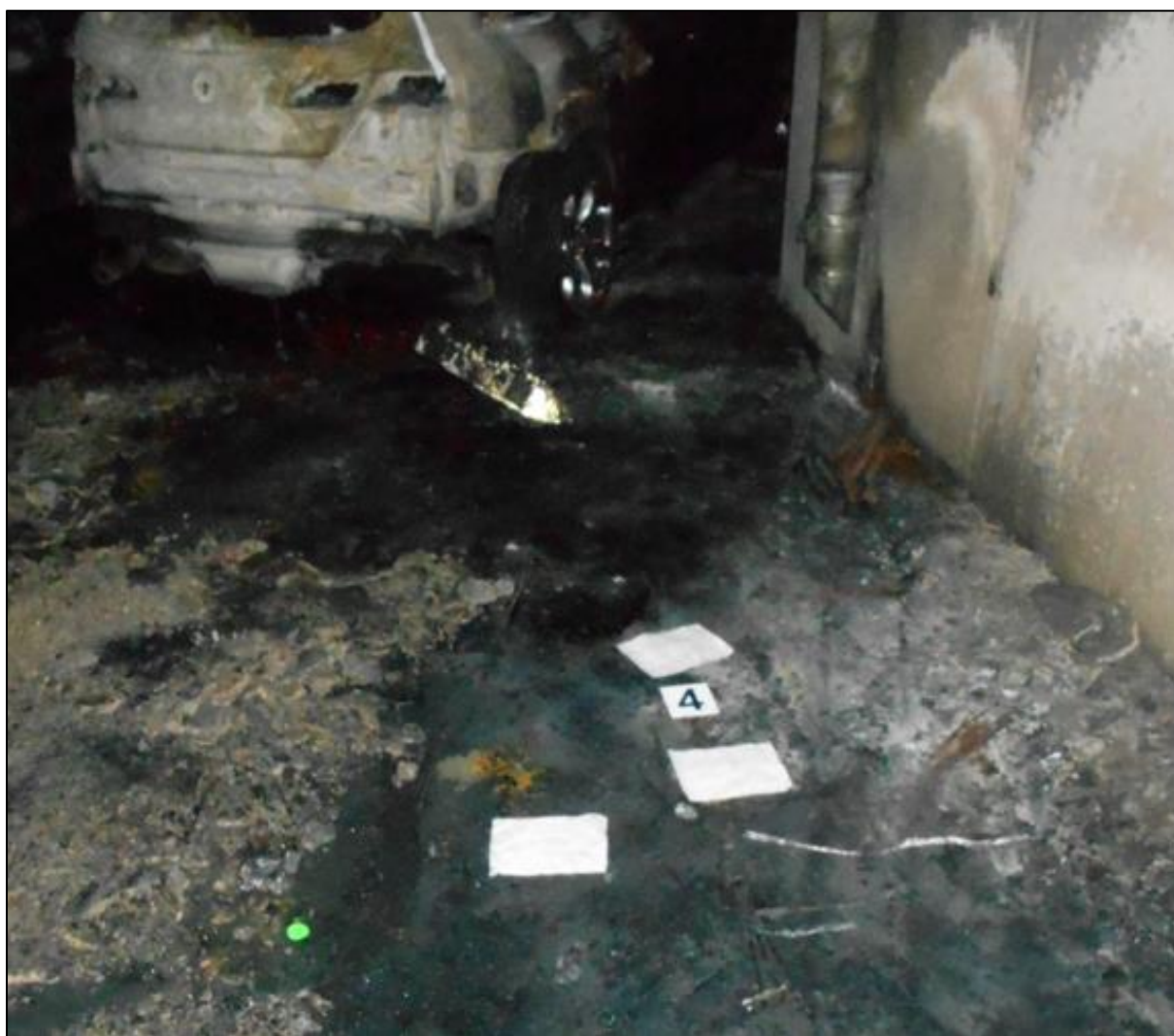
20. kép: A talajszintről vett „gőzcsapdás” mintavételt éles helyzetben is volt lehetőség kipróbálni, jól láthatók a négyzet alakú speciális mintavételi textilek (készítette a szerző)
