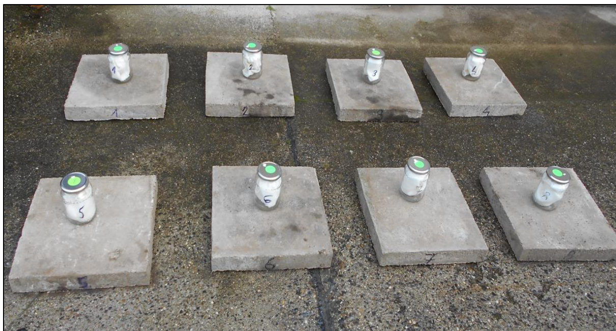
11. kép: A mintavételi edények a begyűjtött mintavételi textil hordozóanyag tartalommal 1 (készítette a szerző)
