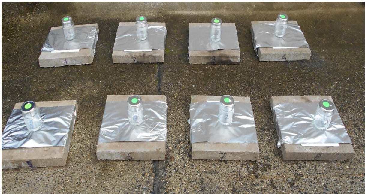
10. kép: A vizsgálatra letakart felületek az előkészített mintavételi edényekkel (készítette a szerző)
