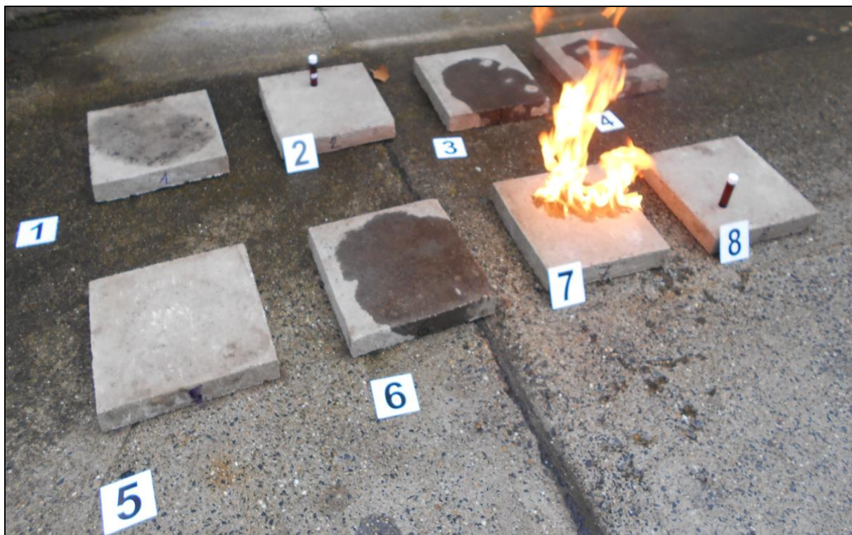
4. kép: A vizsgálati felületekre juttatott éghető anyagok egymást követő meggyújtása (készítette a szerző)
