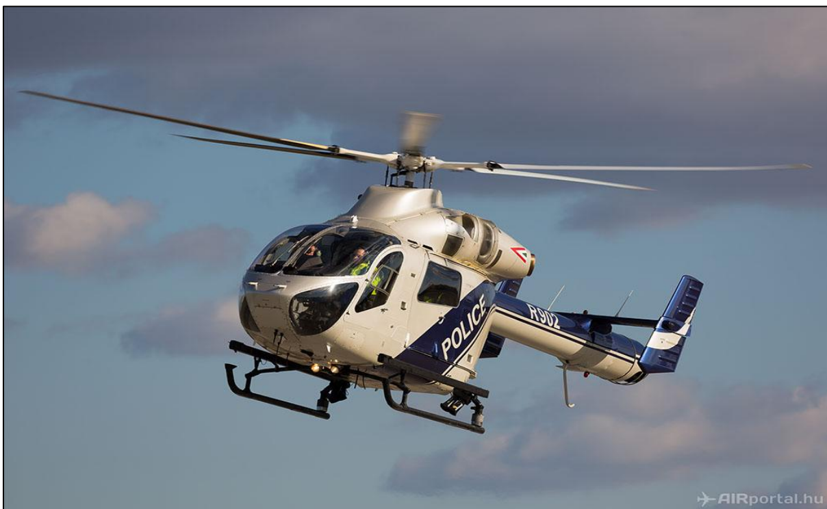
3. ábra: A Készenléti Rendőrség McDonnell Douglas MD902 típusú, farokrotor nélküli helikoptere (Forrás: ld. [4])
