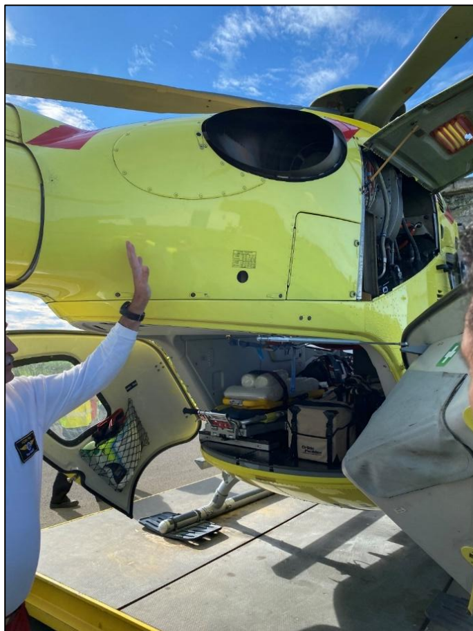
5. ábra: Az AIRBUS HELICOPTERS EC135 P2+ mentőhelikopter hajtóműve (készítette a szerző)
