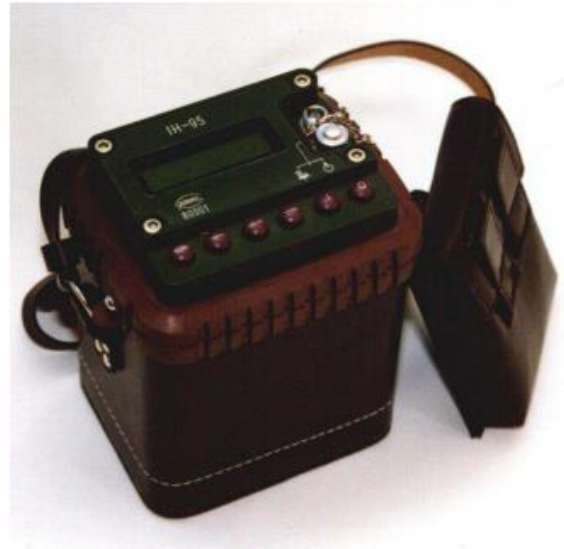
1. kép – IH-95 sugárszint- és szennyezettség-mérő műszer (forrás: Gamma Műszaki Zrt.)
