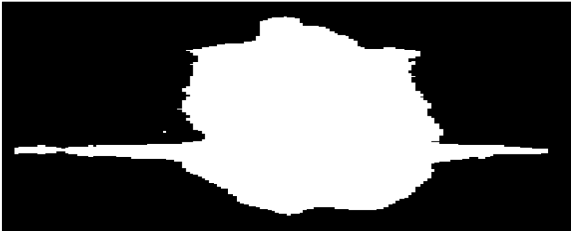
8. ábra: Egymás melletti rétegek illesztésénél található hézag rétegelt lemez mintában a beégett térfogat szegmentált bináris maszk szeletén (készítették a szerzők)
