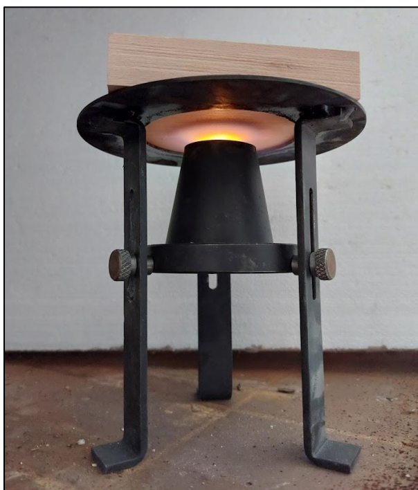
1. ábra: Lindner módszeres beégés vizsgálat, vizsgálati elrendezés (készítették a szerzők)
