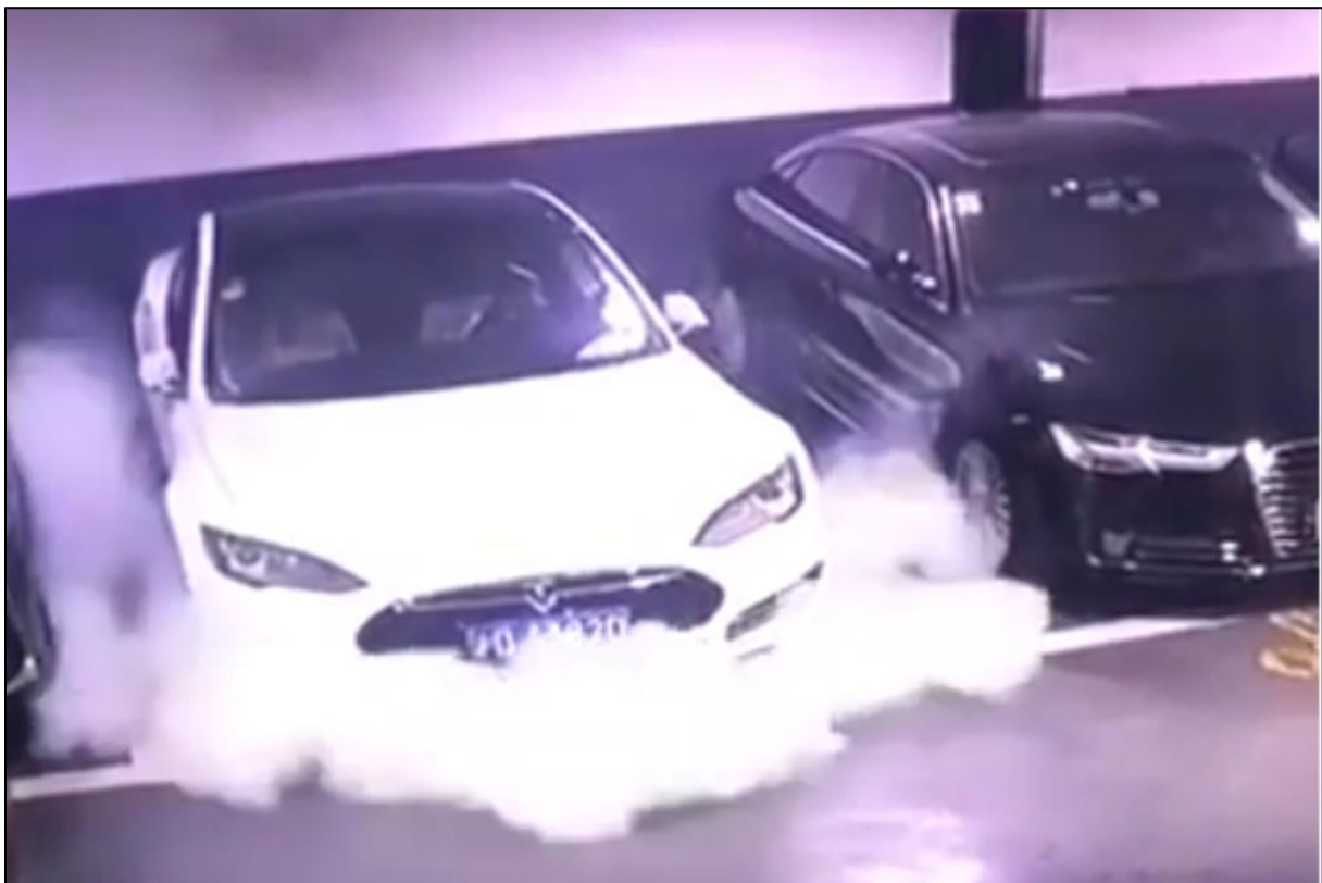
8. ábra Tesla akkumulátorának termikus kifutása Shanghai - Kína 2019. (Forrás: ld. [8])
