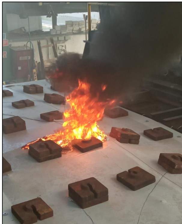
5. kép A vizsgálati próbatest, tartós lángáttörés
