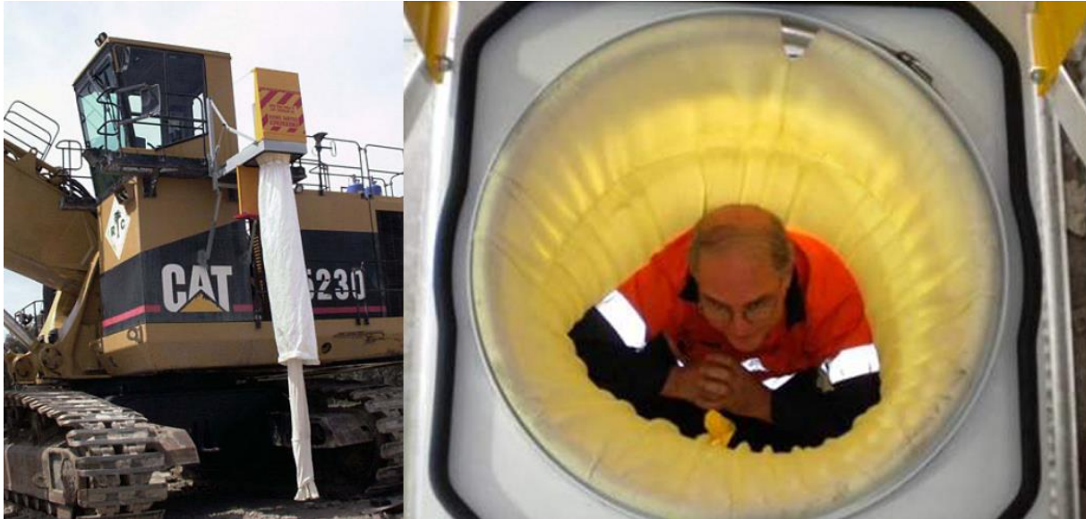
30. ábra: Beépített mentőtömlő egy kotrógép oldalán. 14
