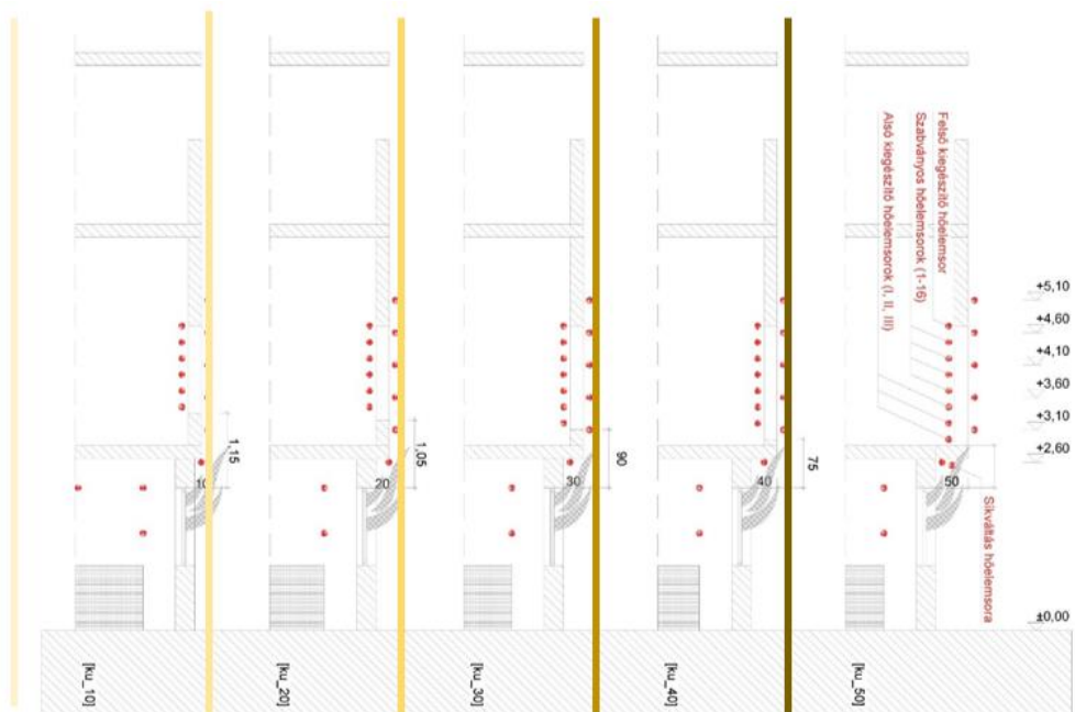
8. ábra: A megvizsgált előreugró homlokzati konfigurációk metszetei (a színekódok a későbbiekben bemutatott grafikonokon történő azonosítást szolgálják)
