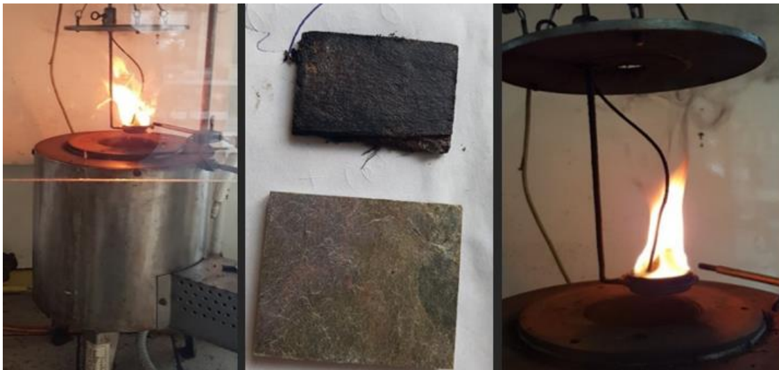
11. kép: „B” minta füstölgése sugárzó hő hatása alatt és utni állapotban. A rétegek felszakadása nem látható. Készítette: A szerző.
