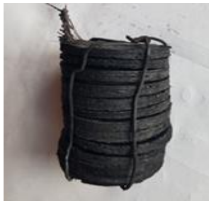
6. kép: „A” minta viselkedése 30-50 cm-s lánggal és erős kormozó füsttel égett. Készítette: A szerző.
