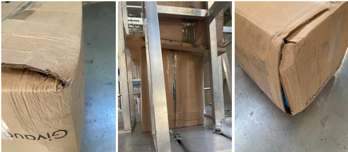
12-14. ábra: ISTA 3A szerinti vizsgálat eredménye, 3. verzió
