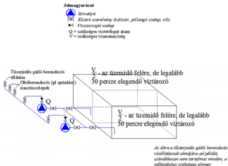
4. ábra. Példa fokozott biztonságú vízforrás kialakítására
