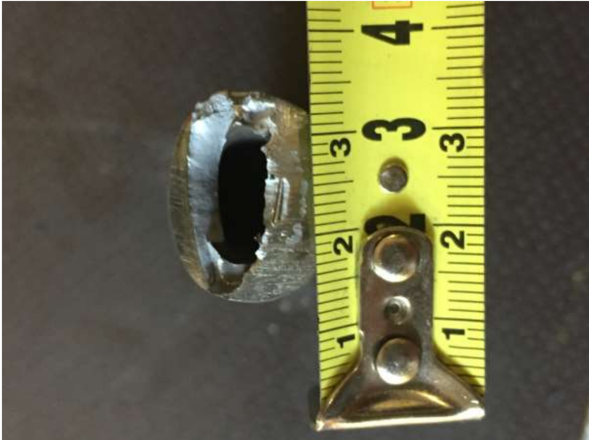
4. ábra Vastagfalú acélső vágási felülete szobahőmérsékletű vágás után
