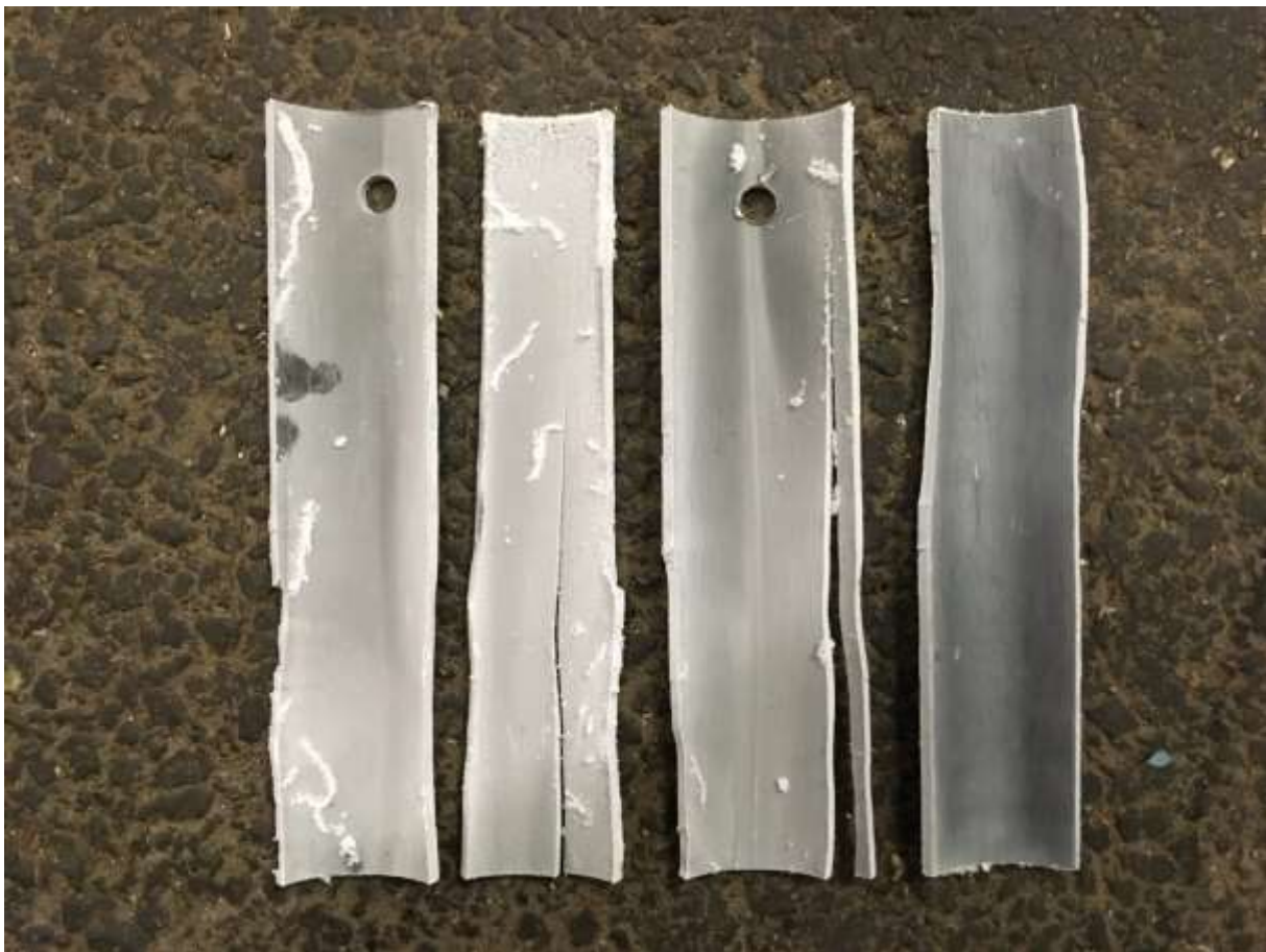
6. ábra A feszítővel összetört próbatest
