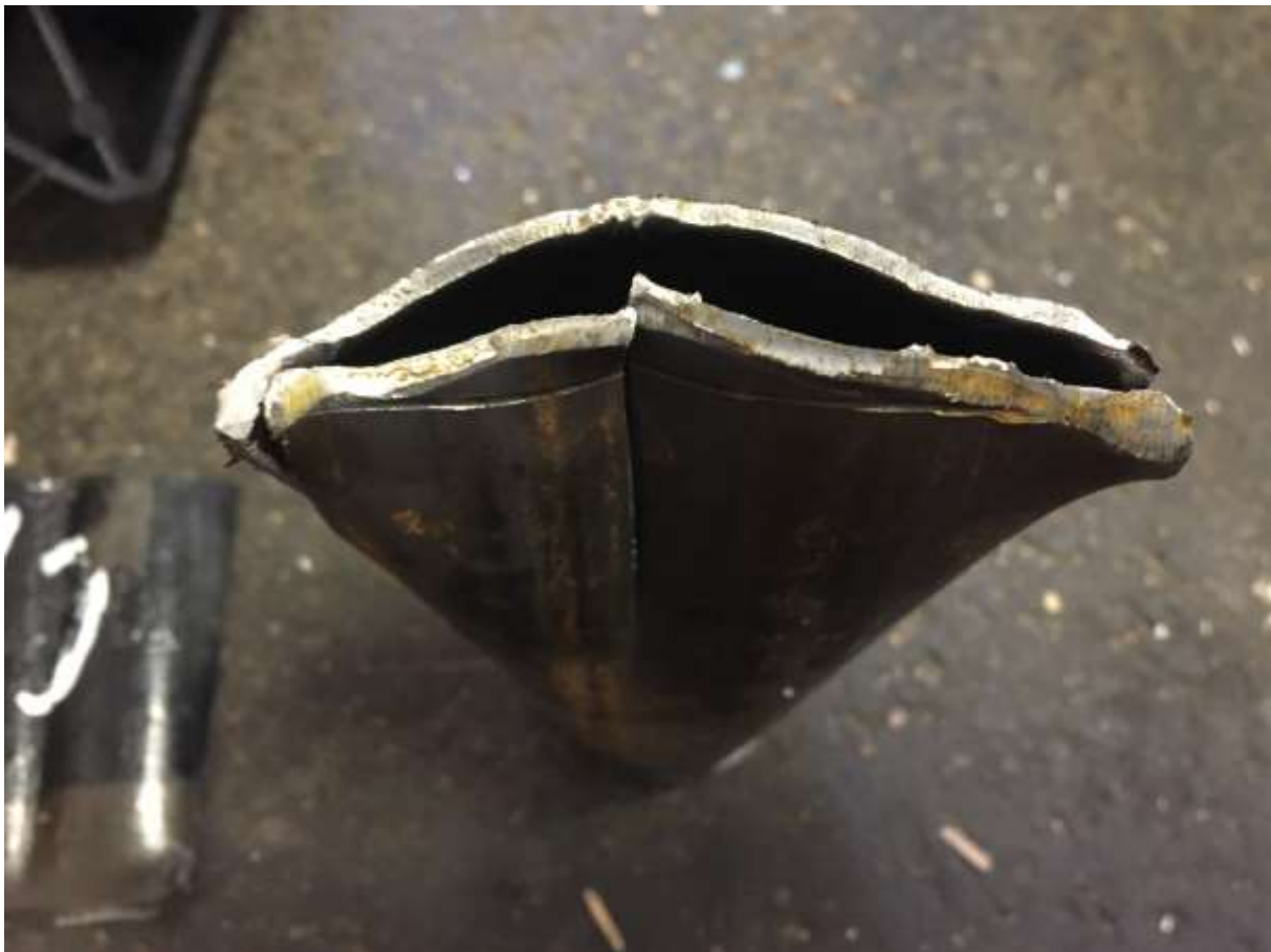
2. ábra Nitrogénnel hűtött acélcső a vágást követően
