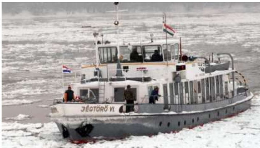
6. ábra: „Jégtörő VI.” Az utolsó döngölő berendezés nélkül épült dunai jégtörő hajó 2017-ben Szerbiában
