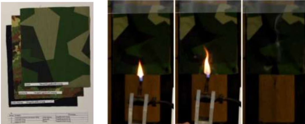
12. kép. Háromrétegű minta IX.minta és égése
