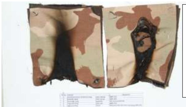
15. kép. Ötrétegű minta (X) égés után eredménye.
