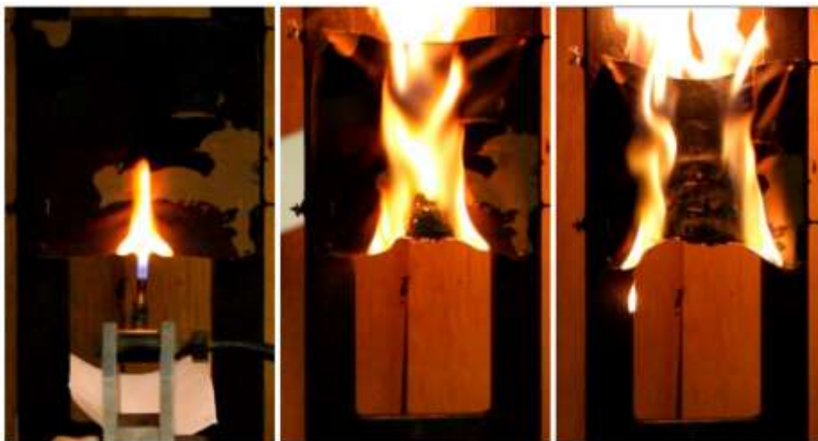
6. kép Kétrétegű minta ( I.) égése.
