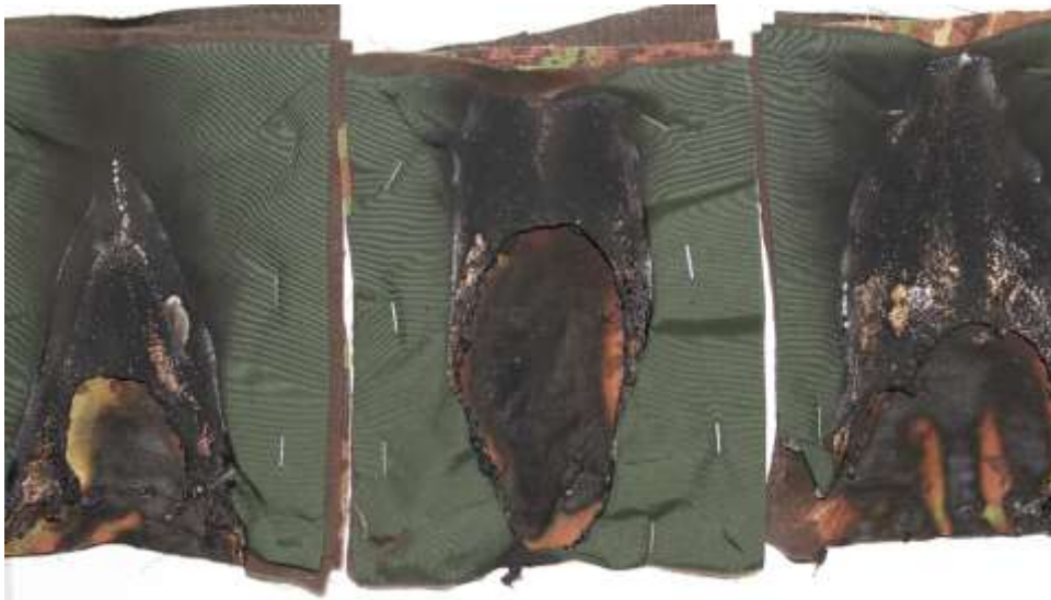
16. kép. Ötrétegű minta (XI) égés után eredménye
