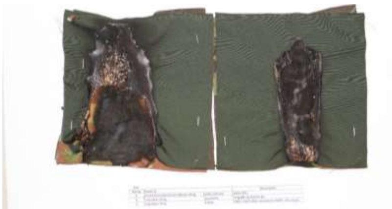
11. kép. Háromrétegű minta VIII. károsodása.
