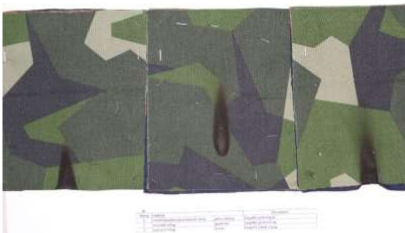
13. kép. Háromrétegű minta IX.minta károsodása
