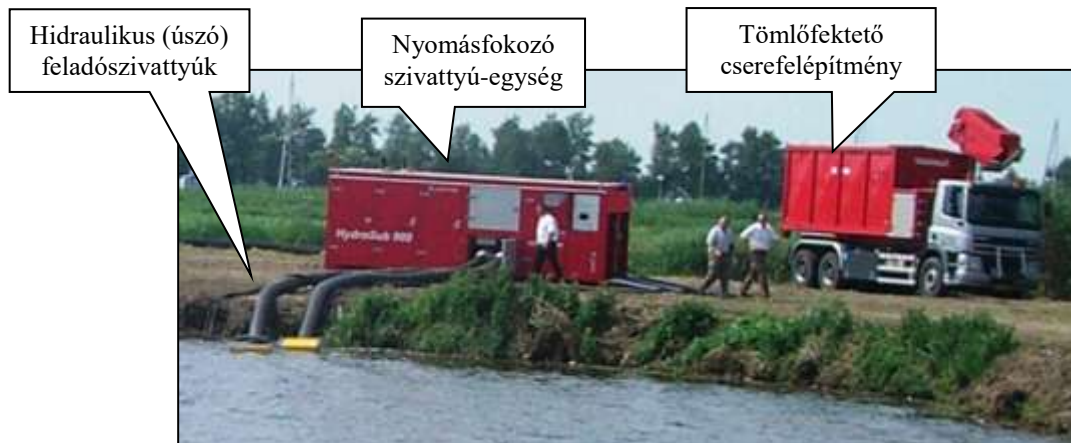
3. ábra: HFS nagyteljesítményű mobil tűzi-víz ellátó rendszer
