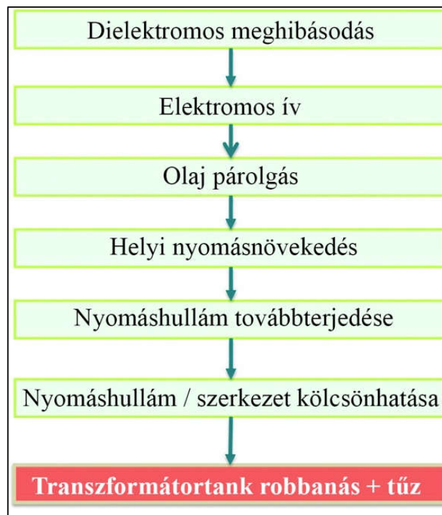
5. ábra: Transzformátortűz kialakulásának folyamata [13]
