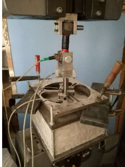
7. ábra – Kihúzó kísérlet kialakítása
