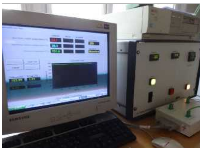
1. ábra: Neméghetőségi vizsgálathoz használt kemence és vezérlőegység (YMÉK Tűz és katasztrófavédelmi Intézet, Tűzvédelmi labor)
