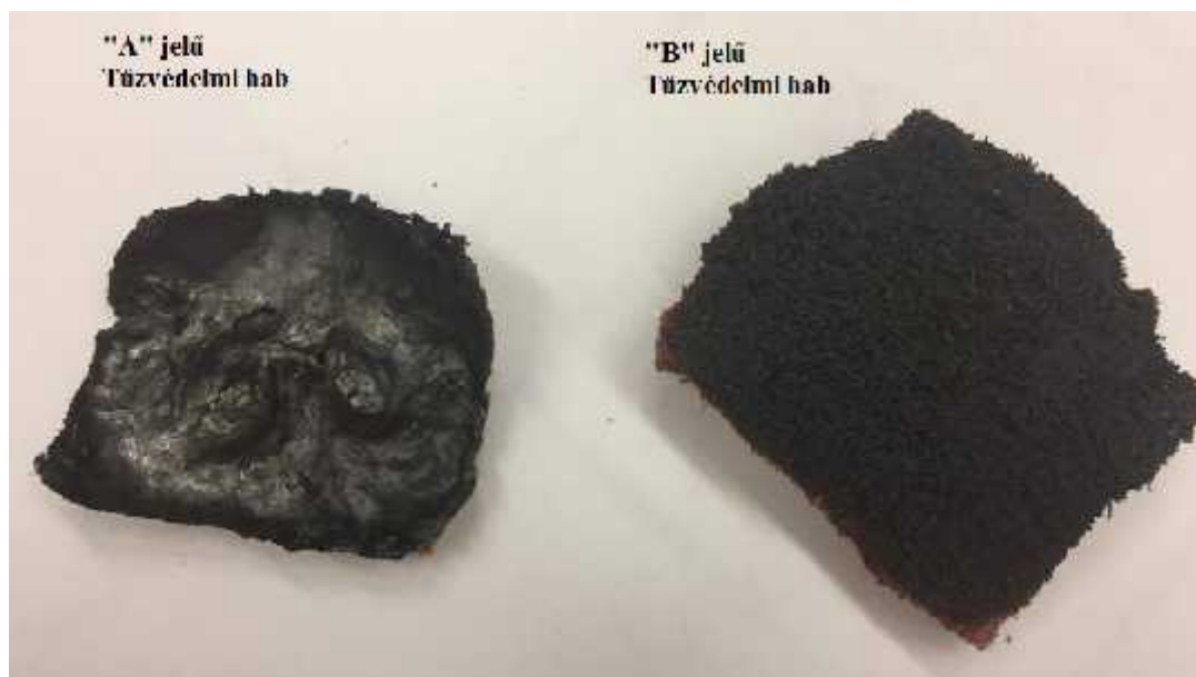
8. ábra: Vizsgálat utáni állapot: méretzsugorodás és elszénesedés
