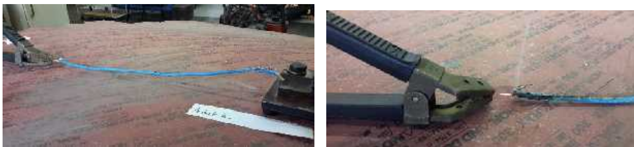
5. ábra: 98 °C és 30 amper: két végér l kezd szenesedni, a közepén sokkal kisebb deformációk. Forrás: szerz k
