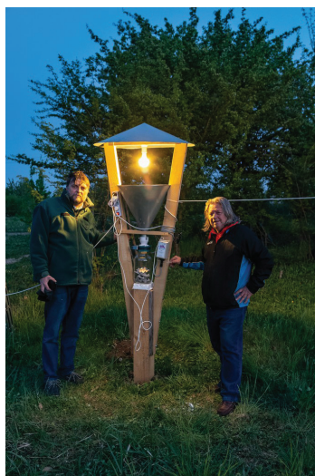
3. ábra. Jermy-csapda sárga LED-del és Zoolog szondával felszerelve.
