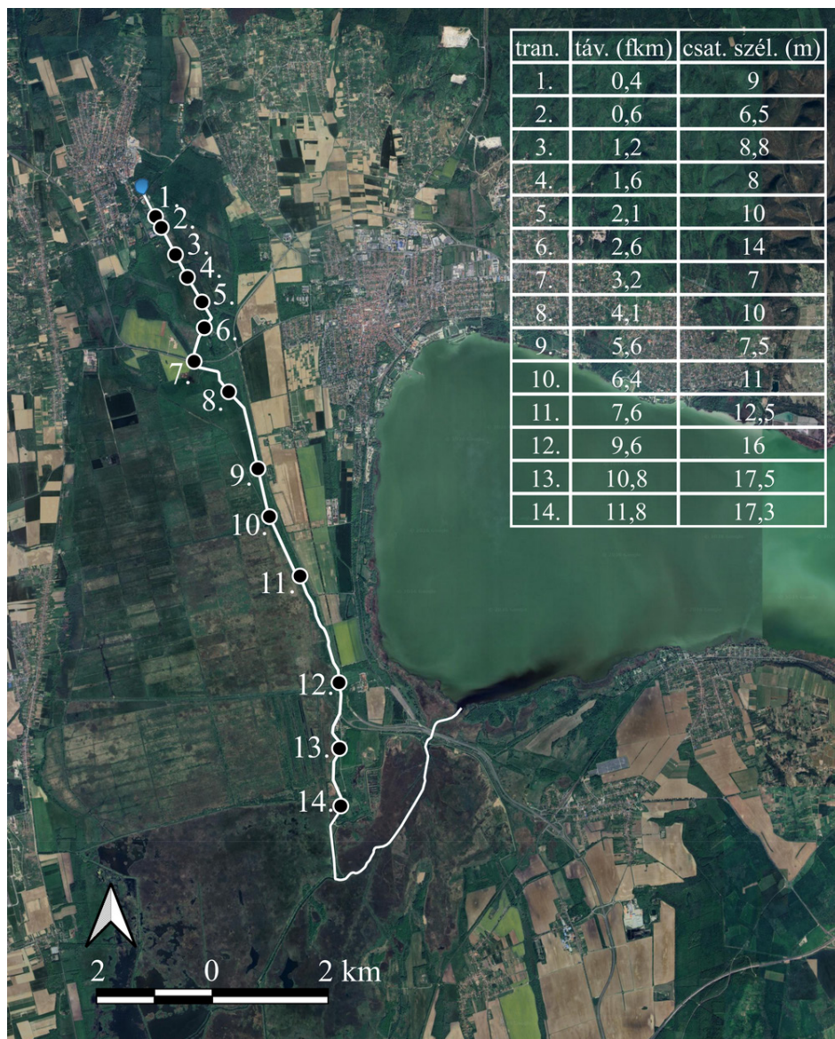
1. ábra. A Hévízi-tóból (kék folt) kiinduló Hévízi-kifolyó (fehér vonal) és a 14 db transekt elhelyezkedése (fekete pont) műholdas felvételen ábrázolva (Google Earth). Táblázatos formában feltüntettük a transektok távolságát Hévízi-tótól, és a csatorna szélességét az adott transektnél.
