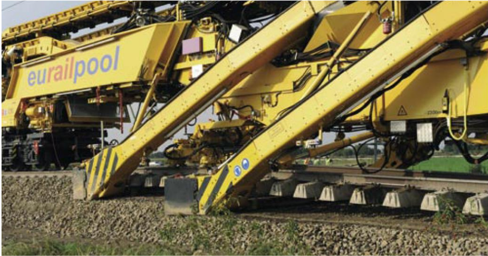
1. ábra. A PM100 URM első és második kaparólánca munka közben
