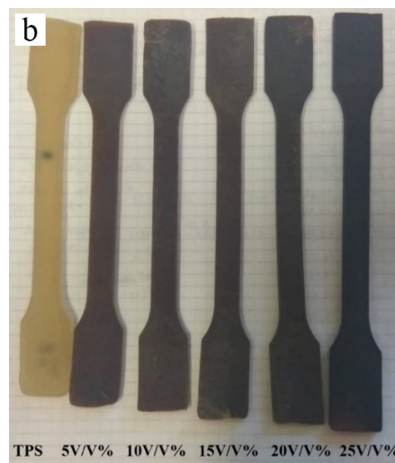
10. Ábra. A szerves töltőanyagok hatása a TPS kompozit jellemzőire. (a) Különböző falisztek vízmegkötést csökkentő hatása; (b) A TPS zsugorodásának csökkenése a kitozán tartalom (0-25%) növekedésével
