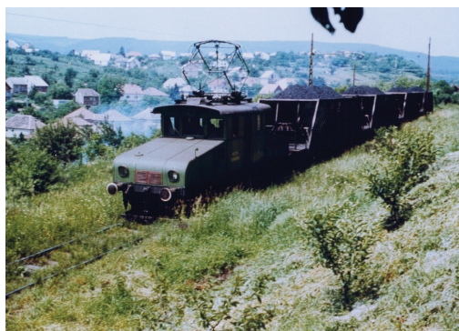
23. ábra: A Pécsi Bányavasutak II.-es számú Ganz-villanymozdonya (1914-1988), Talbot-típusú vagonjaival (1914-1989) szén szállít a pécsbányatelepi Gróf Széchenyi István-aknáról Pécsújhegyre. (Széchenyi-akna iparvágány, Kormoskősor – Blaha Lujza utca közötti gyalogos vasúti átkelő. Fotó: Lakos Rudolf, 1978.)
