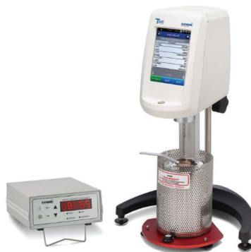
4. ábra: Brookfield-viszkoziméter (forrás: saját kép)
