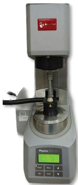
3. ábra: Dinamikus nyíró reométer (forrás: saját kép)
