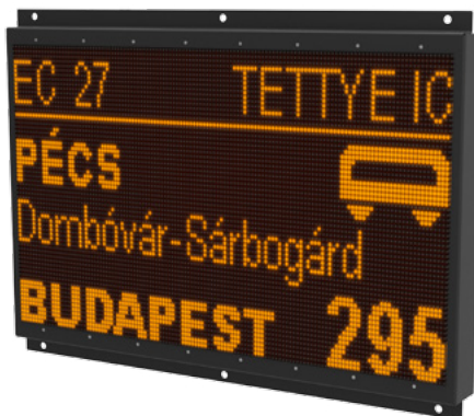
2. ábra: Vasúti járműfedélzeti külső és belső utastájékoztatói rendszer hardver elemei
