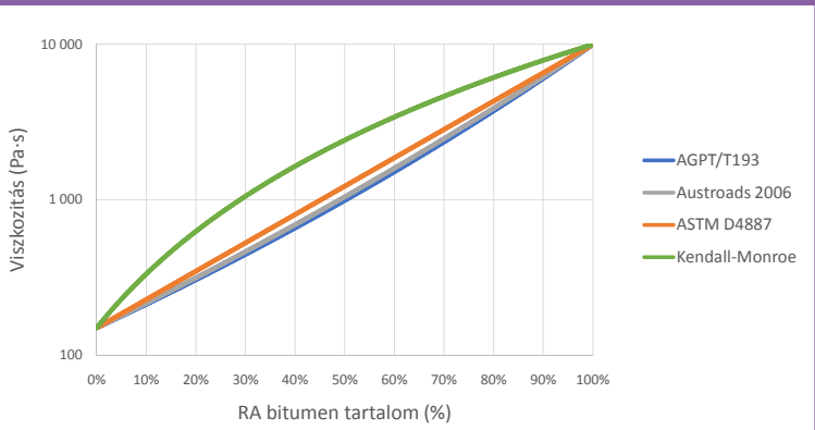
1. ábra: Útépitési és RA-bitumen elegyének viszkozitása az RA-bitumen tömegaránya szerint, különböző képletek alkalmazásával, logaritmikus léptékben
