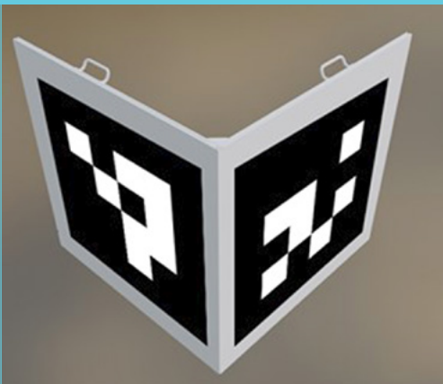
4. ábra: A kalibrációs objektum modellje
