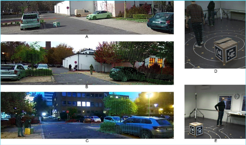
8. ábra: A LiDAR pontfelhő pontjainak képre vetítése a kiszámított kalibrációs paraméterekkel, az 1. táblázat alapján
