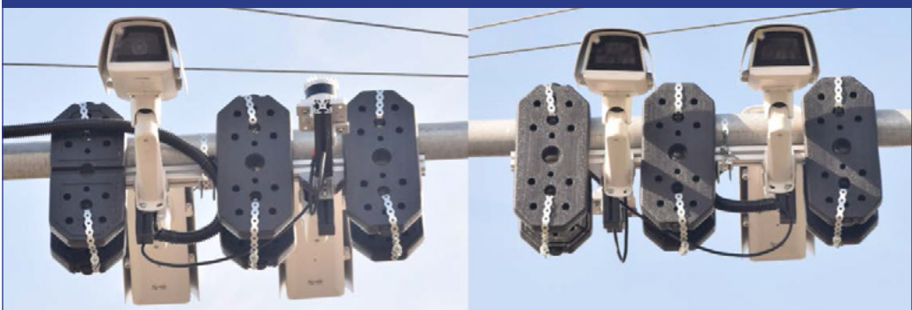
3. ábra: A kísérleti szenzorok és a nehezek, amelyek a végső szenzorfürt tömegét modellezik
