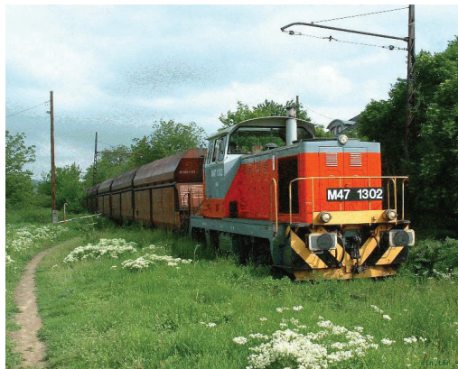
30. ábra: A MÁV-szerelvény: a Dacia-dízelmozdony (1988–2004) és a Fals típusú vagonok (1989–2004) szénét szállítanak Gróf Széchenyi István-aknáról Pécsújhegyre, a Szénosztályozóhoz. (Fotó: Uherkovich Péter, 2004. május 14.)
