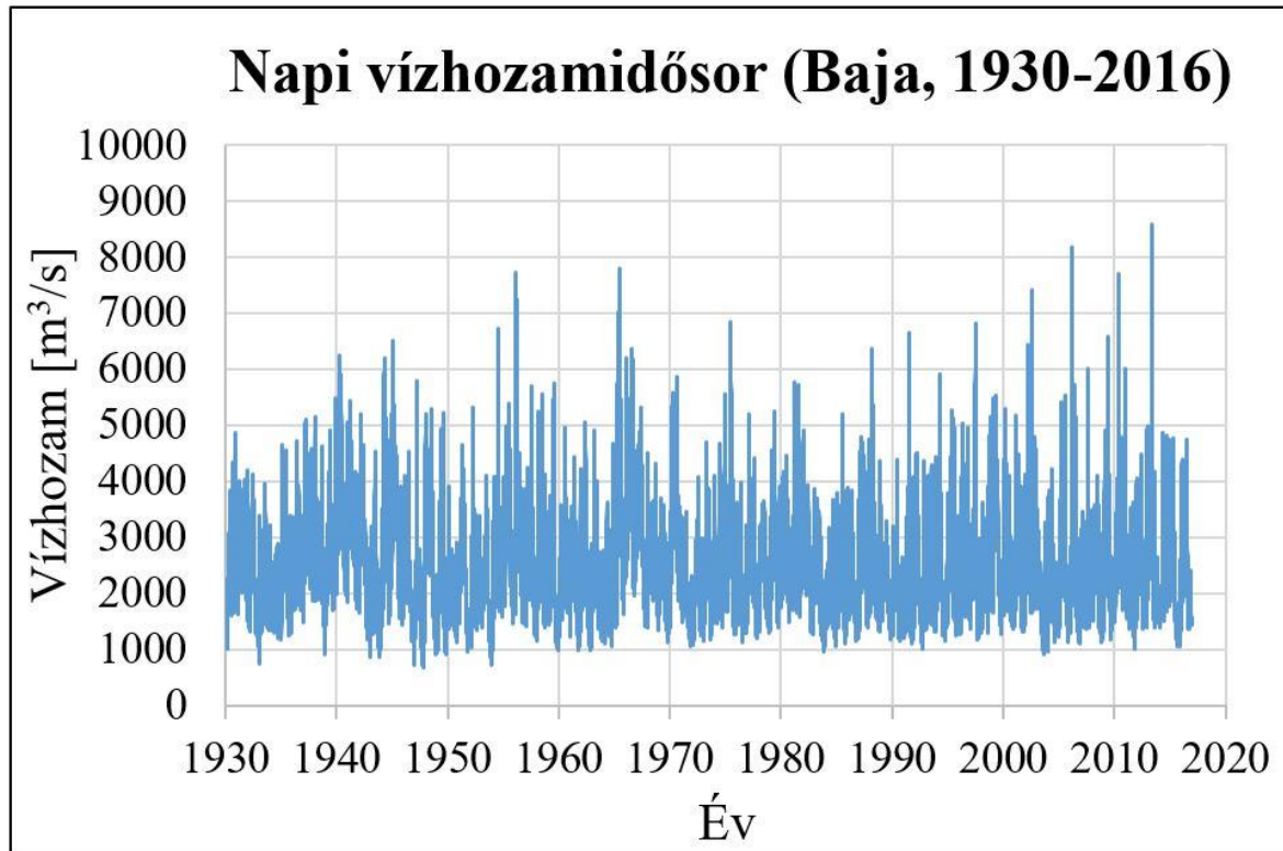
2. ábra. A bajai vízmérce napi vízhozamidősora 1930 és 2016 között Figure 2. Daily flow discharges at Baja gauge station between 1930 and 2016
