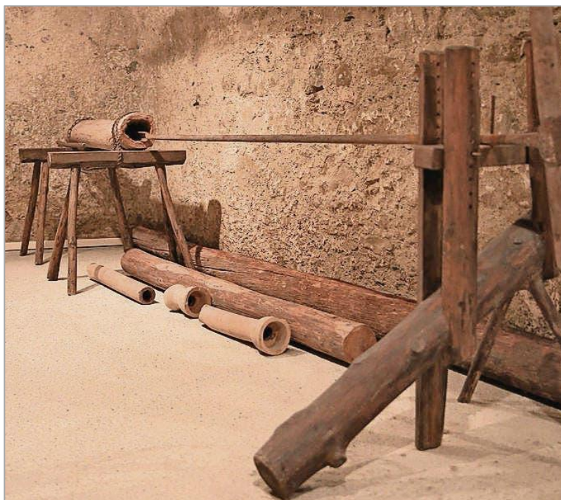
14. fotó. Rekonstruált kézi facső fúró egy svájci múzeumban (URL6) Photo 14. Reconstructed hand-held wooden pipe drill in a Swiss museum (URL6)
