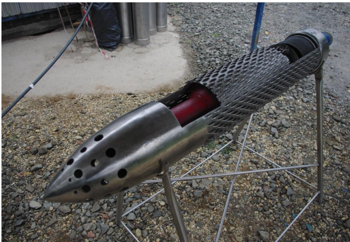
Egy csápos kút csápjának kihajtásához használt indítóelem (Nyíri Gábor felvétele)
