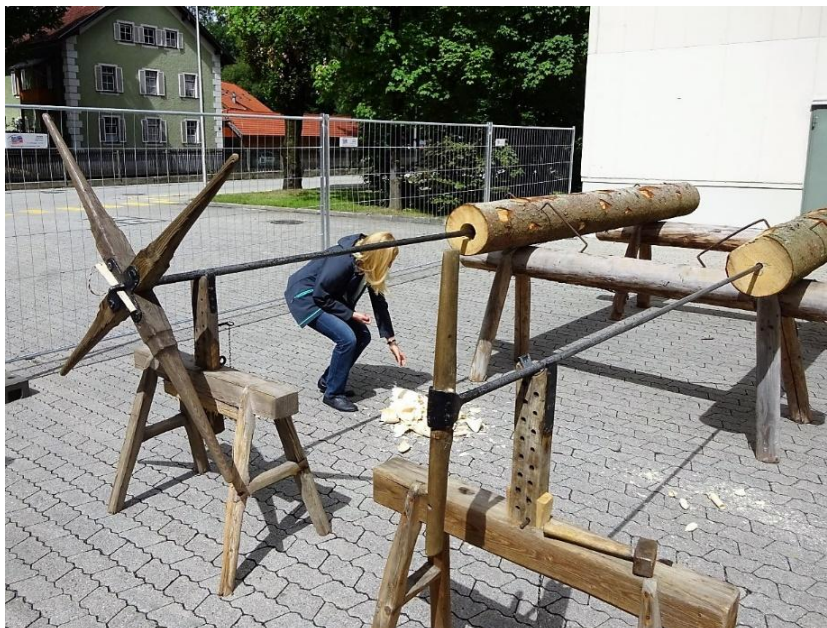
15. fotó. Facső kézi kifűrésésének rekonstrukciója napjainkban (URL7) Photo 15. Reconstructoin of hand-drilling a wooden pipe in our time (URL7)
