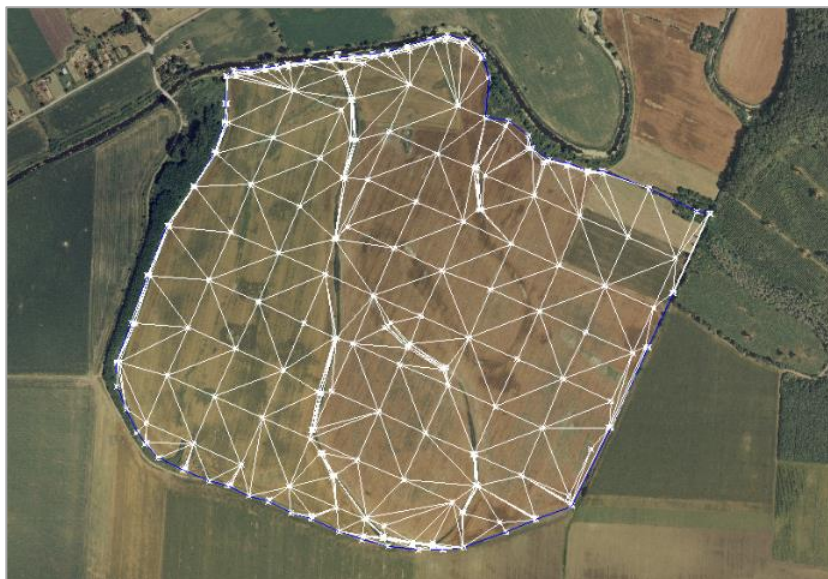
9. ábra. Az elkészített TIN felület képe az AutoCAD Civil 3D programban (Képernyőfotó: Luczó Á.) Figure 9. Image of the TIN surface in AutoCAD Civil 3D (Screenshot by Á. Luczó)
