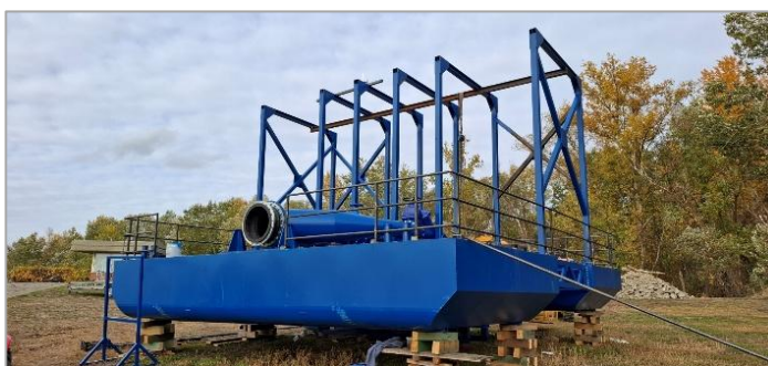
1. kép. A beszerzett úszós vízkivételi mű (ATIVIZIG) Photo 1. The purchased floating water intake unit (ATIVIZIG)
