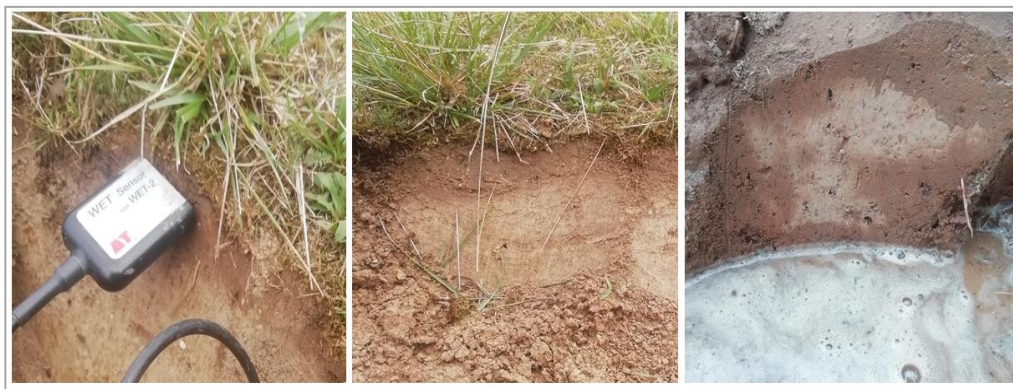
8. ábra. Az erodált ABET talaj altípusra jellemző beszivárgási viszonyok Figure 8. Infiltration conditions of eroded brown-forest soil subtype
