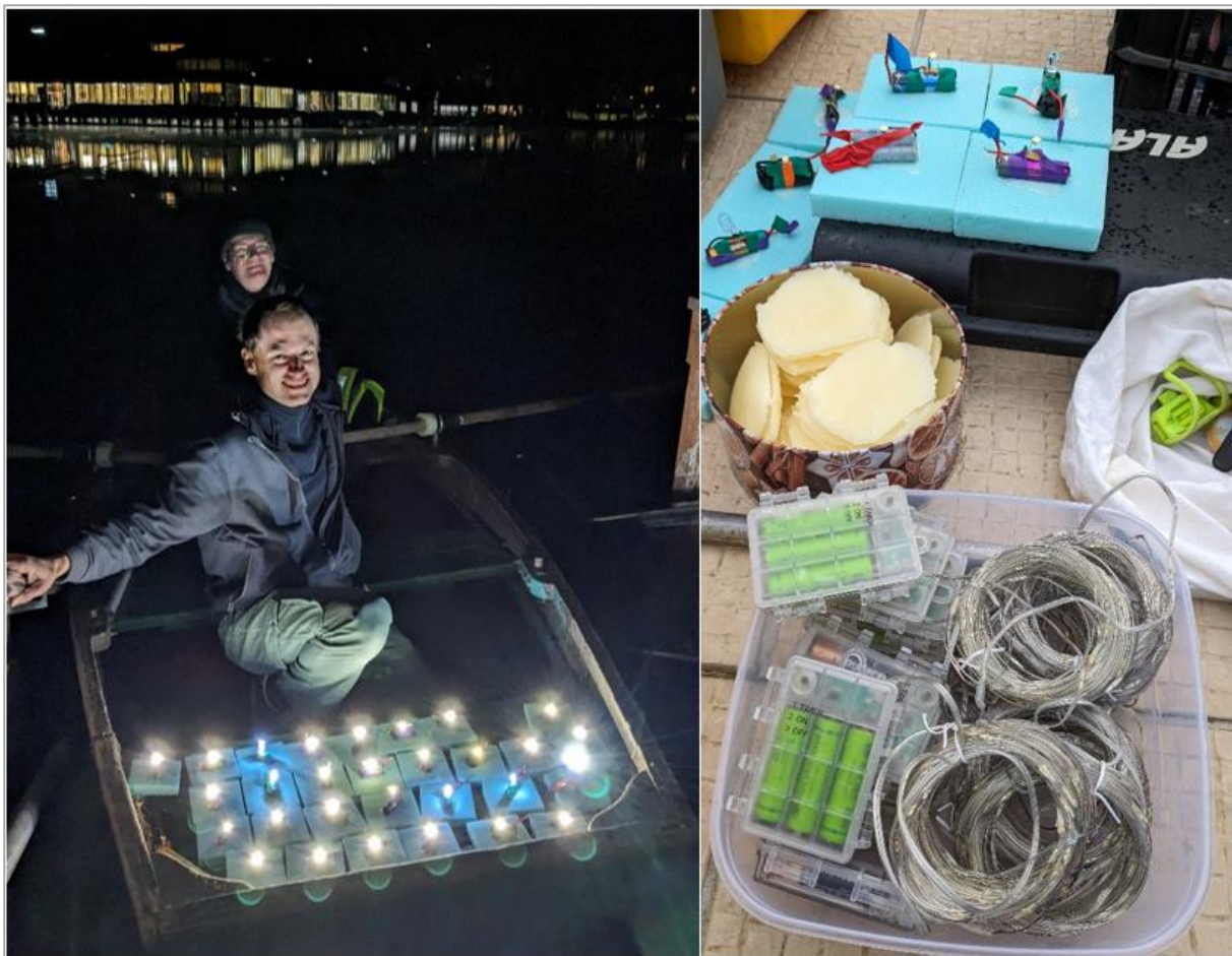
4. fénykép. Jelzőanyagként használt úszó ledek (balra), viaszkorong és ledsorok a fix pontok megvilágításához (jobbra) (Fotó: Nagy Judit Barbara)
