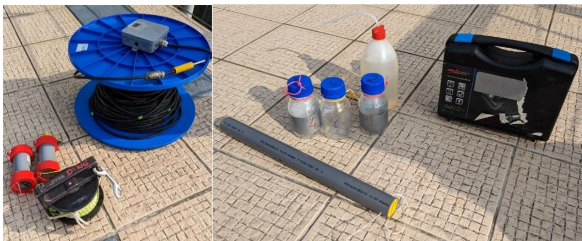
2. fénykép Balra a hőmérsékletméréshez, jobbra a vízmintavételre használt műszerek (Fotó: Nagy Judit Barbara) Photo 2. Instruments used for temperature measurement are on the left, and instruments used for water sampling are on the right (Photo by Judit Barbara Nagy)
