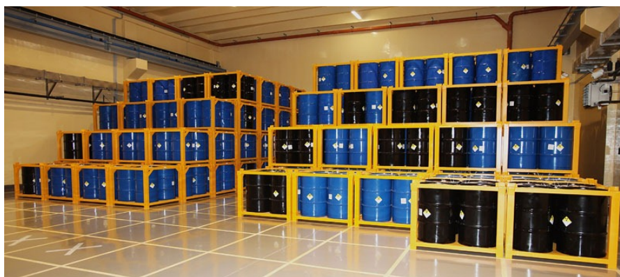
6. ábra: Acélkeretekbe zárt, nukleáris hulladékot tartalmazó hordók, Bataapátiban (RHK nagyfelbontású fotótár)
