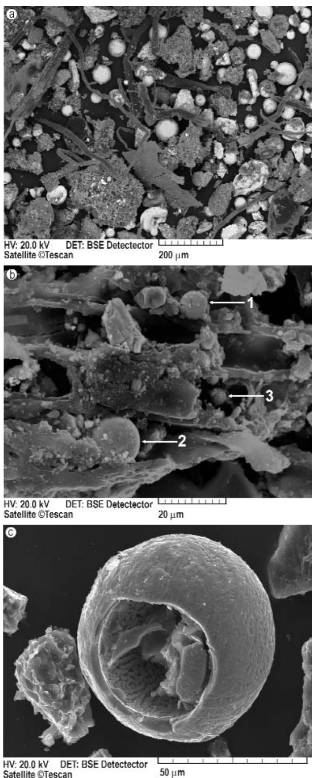
6. ábra. SEM felvételek a leülepedett porminták mágneses részecskéiről a) szferulák tömeges előfordulása (DAM Rt.), b) 1. és 2. majdnem tiszta vas- (vas-oxid-) szferulák kevés Zn, Ca és Mn tartalommal, 3. Túlnyomóan vas-, vas-oxid-szferula kevés Zn-, Mn-, Si- és Cr-tartalommal (Kömlesztő), c) szferula szerkezete (DAM Rt.)
