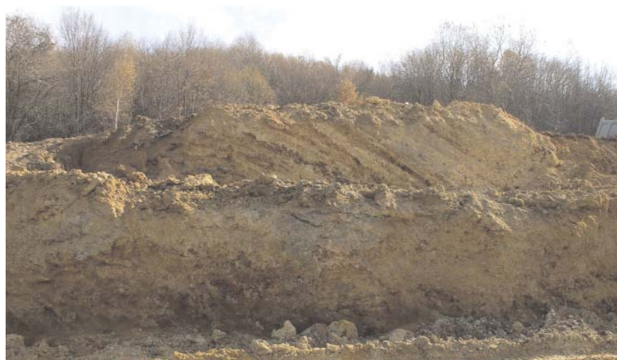
2. ábra. A bányabérci meddőhányó feltárt fala. A felső részben a vöröses és sárga rétegek váltakozása látható
